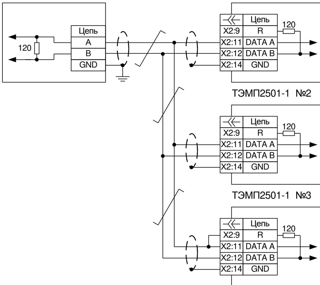
Рисунок В.4 – Схема подключения устройств ТЭМП 2501-1 исполнения RS-485 к устройству сопряжения
