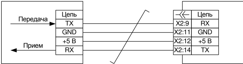
Рисунок В.3 – Схема подключения устройства ТЭМП 2501-1 исполнения TTL к отдельному каналу связи устройства сопряжения
