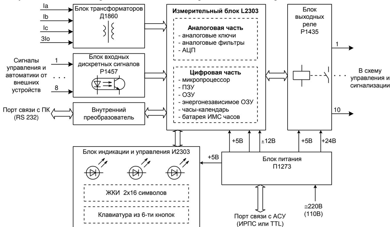
Рисунок 1 – Структурная схема устройства
