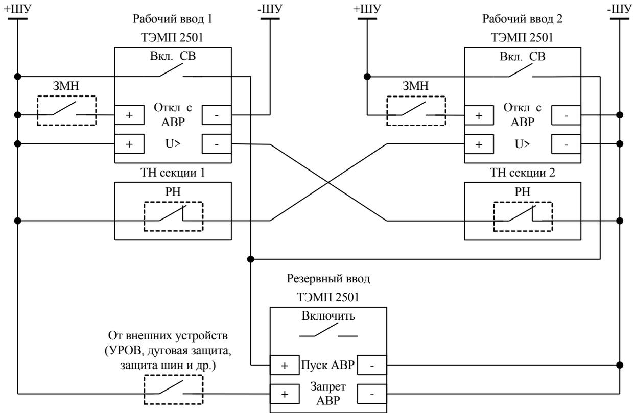
а) схема с контролем напряжения смежной секции устройствами защиты рабочих вводов
