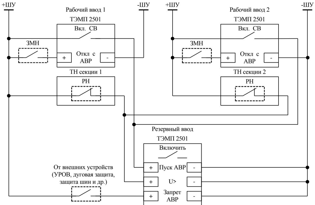
б) схема с контролем напряжения на секциях устройством защиты резервного ввода
