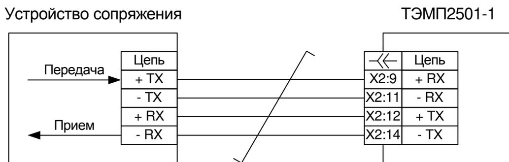
Рисунок В.1 – Схема подключения устройства TЭМП 2501-1 исполнения ИРПС к отдельному каналу связи устройства сопряжения
