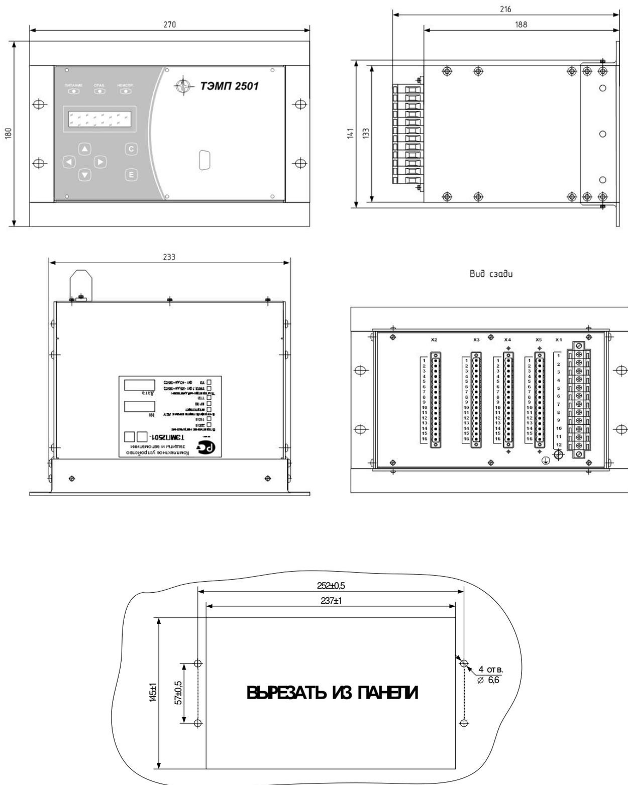
Рисунок А.1 – Габаритные и установочные размеры исполнения ТЭМП 2501-11
