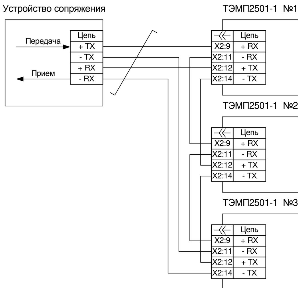
Рисунок В.2 – Схема подключения нескольких устройств TЭМП 2501-1 исполнения ИРПС для совместной работы на одном канале связи устройства сопряжения
