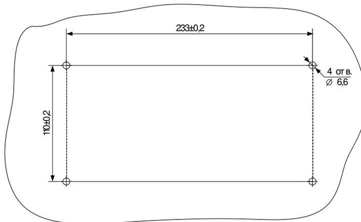
Рисунок А.2 – Габаритные и установочные размеры исполнения ТЭМП 2501-12
