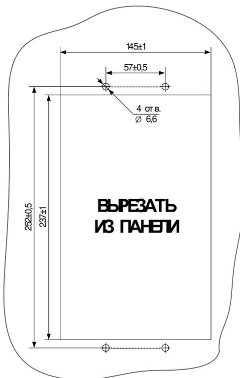
Рисунок А.3 – Габаритные и установочные размеры исполнения ТЭМП 2501-13
